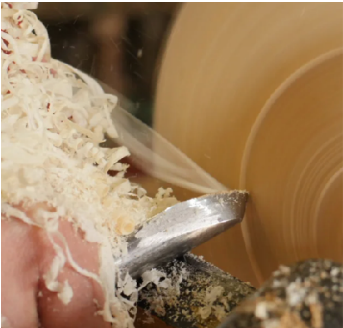
ウッドターニングという技法によるうつわづくりの様子
